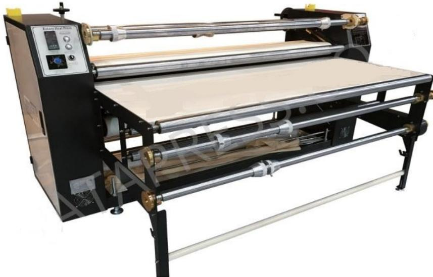
L'AX-PRESS CMI 1726 est une calandre textile multifonctionnelle conçue pour répondre aux exigences de la sublimation industrielle, tant en positionnement qu'en impression continue (roll-to-roll). Équipée d'un système de chauffage à huile et d'un cylindre de 26 cm, elle garantit un transfert de couleur homogène, même sur les travaux grand format.
