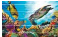
Écart / Traces blanches (Alimentation papier excessive)
